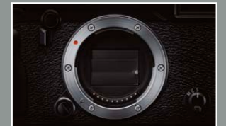
Die X-Pro2 stellt im Auslösemodus „Mechanisch + Elektronisch“ automatisch vom mechanischen auf den elektronischen Verschluss um, sobald die korrekte Belichtung in der Zeitautomatik Verschlusszeiten von weniger als 1/8000 Sek. verlangt.
