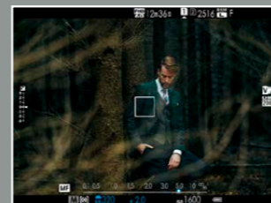
Die Schärfentiefe wird mit blauen Balken angezeigt, die sich vom Entfernungsmaker aus nach links und rechts ausdehnen.
