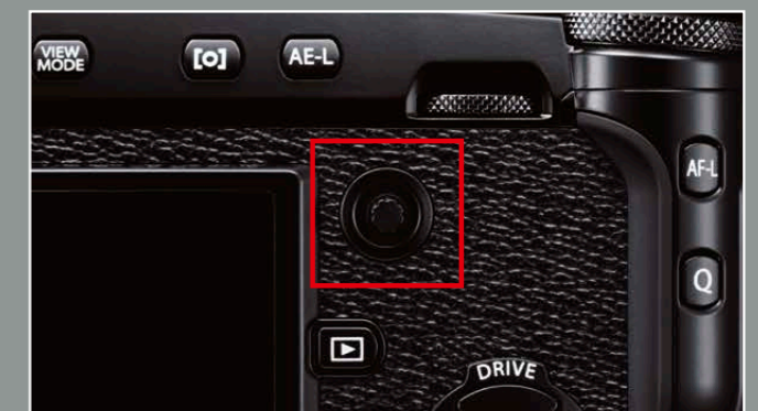
Ein kurzer Druck auf den Fokus-Joystick setzt die Kamera auf das mittlere Fokusfeld zurück.
