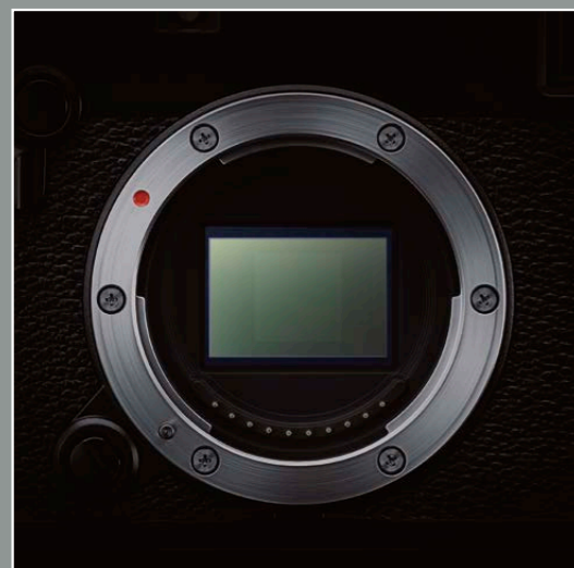
Die Auslesezeit des Sensors wurde annähernd halbiert, was sich positiv auf die Serienbildgeschwindigkeit, die AF-Objektverfolgung und die Videoqualität auswirkt.
