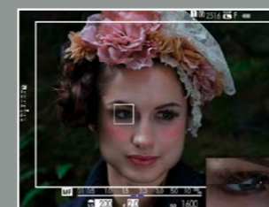
Das digitale Schnittbild steht bei der X-Pro2 nun auch in Farbe zur Verfügung.
