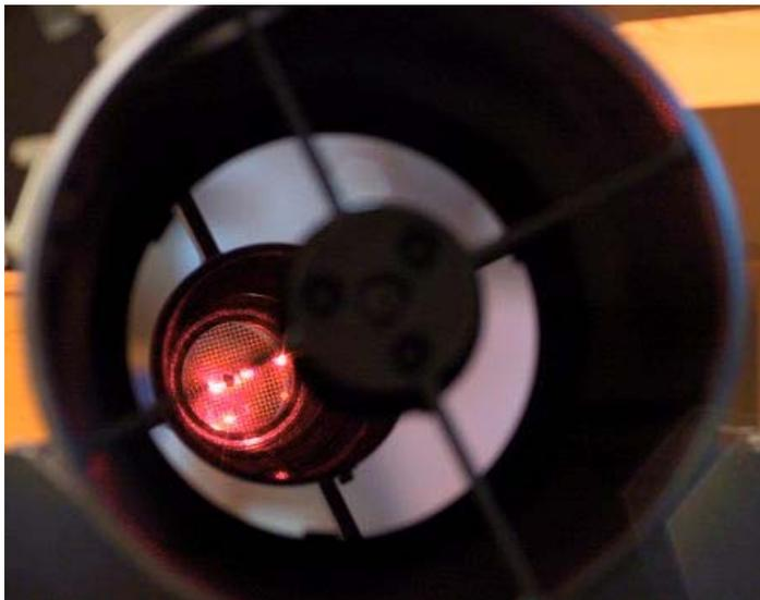
Schauen Sie dazu von vorn in den Tubus hinein. Sie sehen dort auf dem Hauptspiegel eine Reflexion des Fangspiegels (und der Gitterplatte des Laser-Colli™) und auf ihm die mehrfache Reflexion des Laserlichtpunktes.
