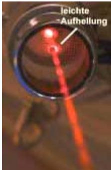
Da der Laserstrahl fast genau so groß ist wie das kleine Loch in der Glasscheibe mit dem Kreuzgitter, ist es bauartbedingt möglich, dass der Laserstrahl den Rand des Loches leicht streift.
