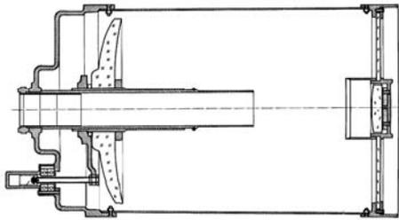
Vereinfachte Skizze des Schmidt Cassegrain Optiks. Drei Schrauben an der Fangspiegelhalterung sind in 120 Grad Abstand zueinander um einen zentralen Stift arrangiert, auf dem der Fangspiegel aufliegt und sich darüber verkippen lässt. Das Lösen der Schraube auf einer Seite und Anziehen auf der anderen bringt den Fangspiegel in die gewünschte Position.
