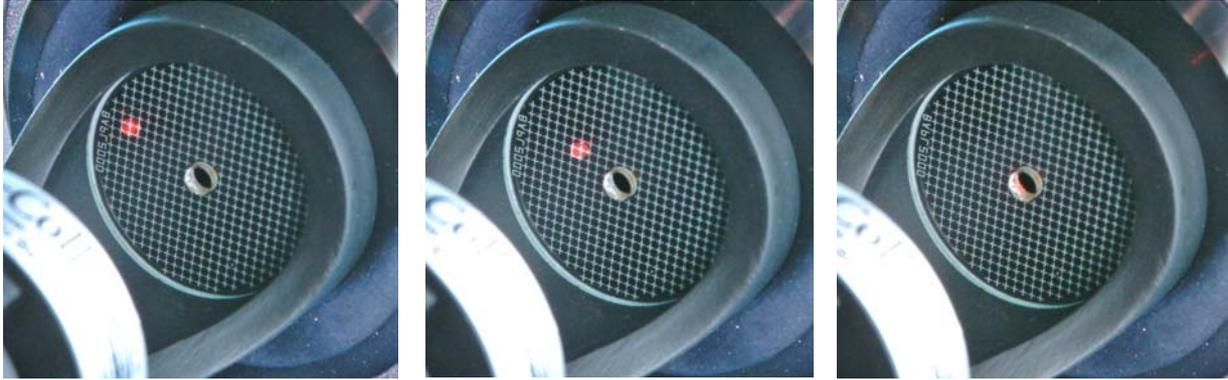
Mit den Stellschrauben den Hauptspiegel so lange kippen, bis der Laserpunkt durchs Loch in sich selbst reflektiert wird. Fertig, Ihr Newton ist perfekt kollimiert. Eine endgültige Kontrolle der Kollimation muß dann am Stern erfolgen (siehe nächste Bilder).
