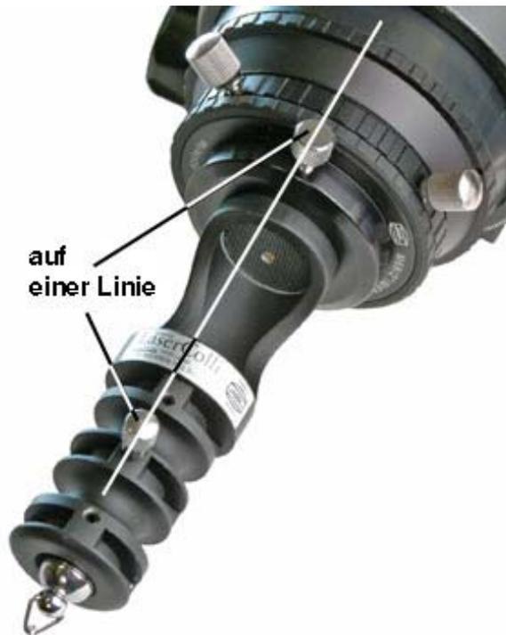
Die Schraube, die als Ein- und Ausschalter fungiert, sollte in einer Linie mit der Klemmschraube in der Okularsteckhülse liegen (siehe auch Abbildung links). Hat Ihre Okularsteckhülse zwei Klemmschrauben unter 120 Grad, sollte der Ein- und Ausschalter des Laser Colli mittig dazwischen liegen.
